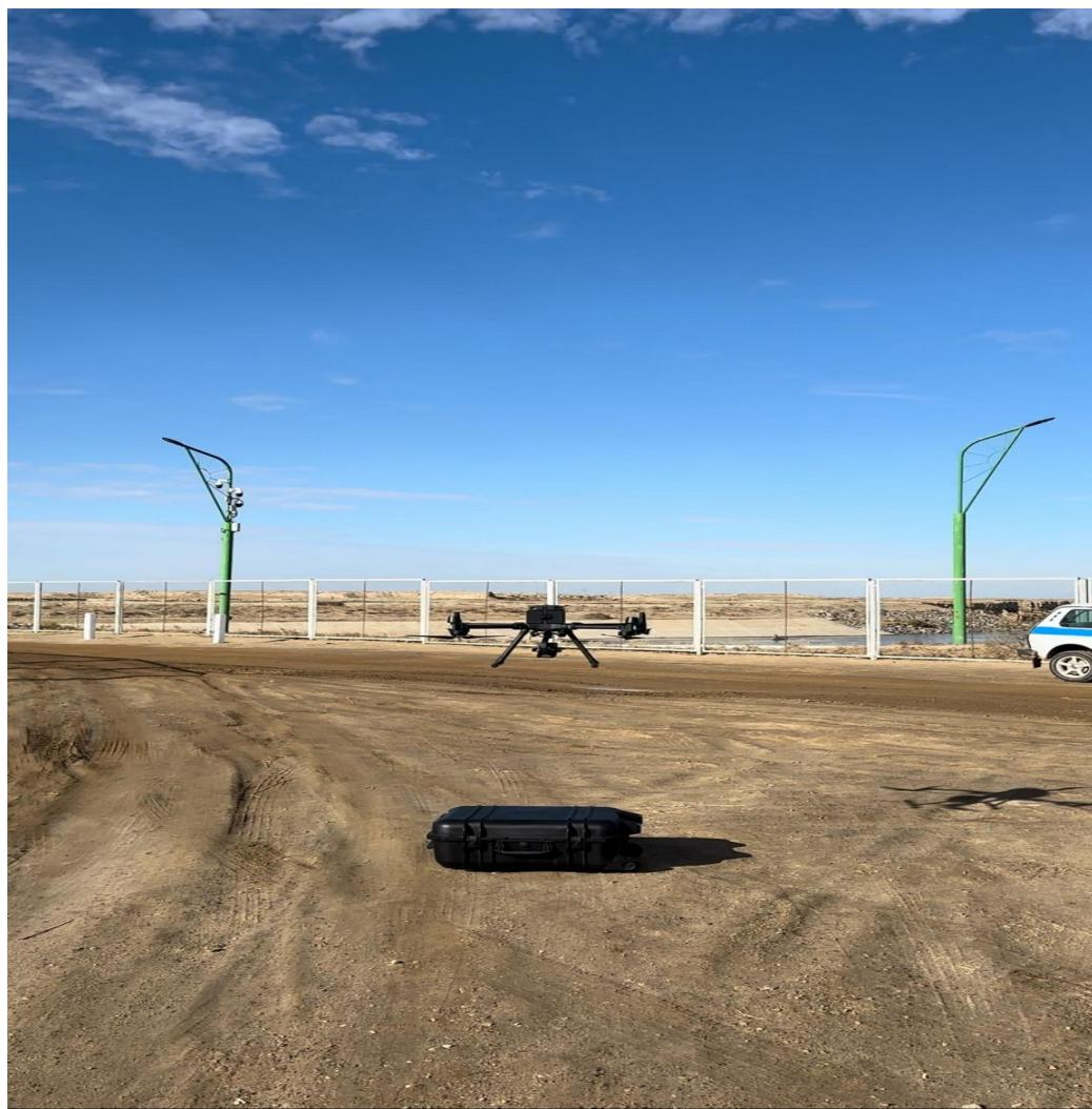
Рисунок 2.3. Обследование гидротехнических сооружений с использованием БПЛА типа «DJI Matrice 300 RTK» с лидаром системы «Лидар DJI Zenmuse L1»
